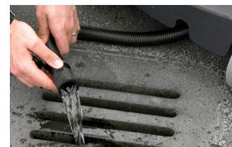
Système d'évacuation des liquides permettant de vider rapidement la cuve des liquides aspirés
